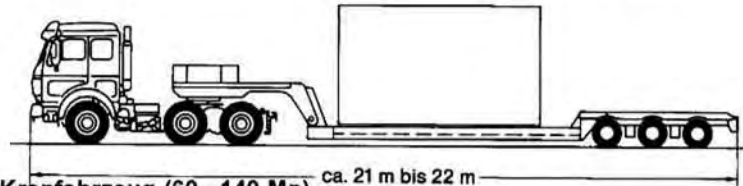
Kranfahrzeug (60 -140 Mp) ca. 21 m bis 22 m
