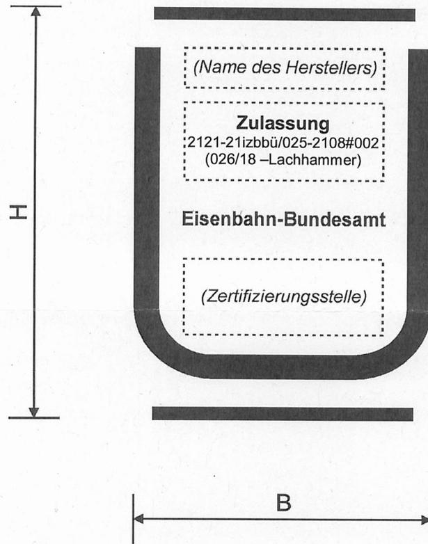
Abmessungsverhältnis (Außenmaß):  $B:H = 0,75 (\geq 4,5\text{cm} : 6,0\text{cm})$
